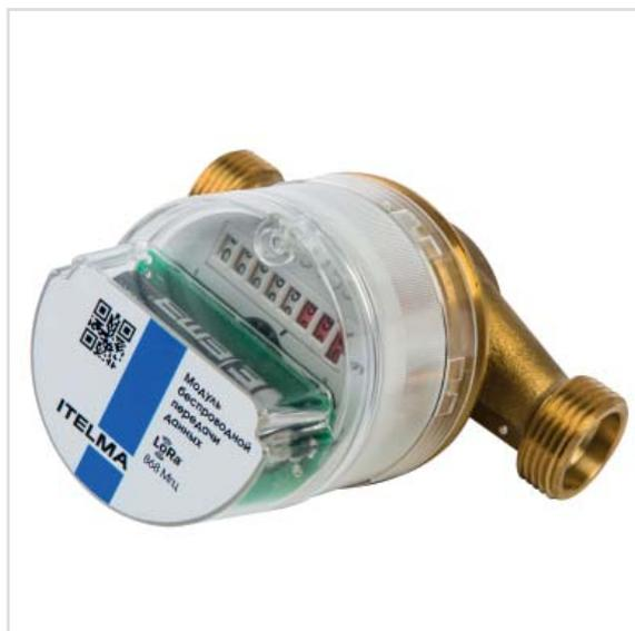
Счетчики с установленным на них радиомодулем предназначены для измерения объема холодной и горячей питьевой воды, протекающей в системах водоснабжения. Модуль радиоканала установлен в специальном корпусе и обеспечивает считывание данных со стрелки долей счетчика. Считанные данные передаются через радиоканал на сервер, где обеспечивается их постоянное хранение и выдача потребителю по его запросу.
